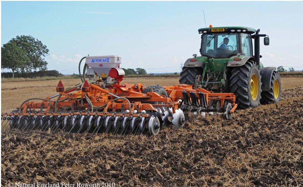
**Figura 6. Minima lavorazione del terreno in un unico passaggio. Riduce la compattazione del suolo, ne migliora la struttura e crea un buon letto di semina.**
