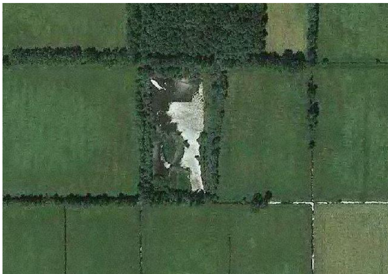
Fig. 4.7 Vista aerea di uno specchio d'acqua, con riflessi biancastri (fenomeno di glitter ).
