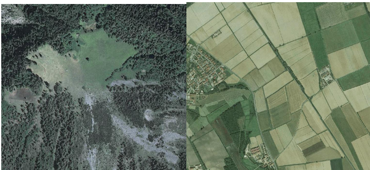
Fig. 4.5 Esempio di ortofoto con aree omogenee caratterizzate da forme e dimensioni proprie. A sx forme irregolari, uso naturale del territorio; a dx forme regolari, uso antropico del territorio.
